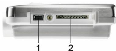
4. Insertar el cable USB en el conector Mini-USB (1).
